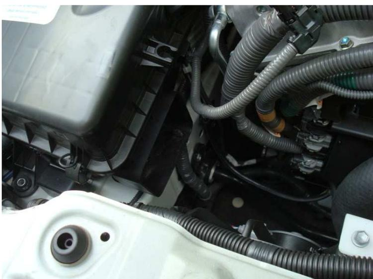
Desserrez la bande qui tient la boîte à air en utilisant un tournevis cruciforme. La boîte à air est tenue par deux boulons de 10mm, un dans le coin supérieur gauche de la boîte et l'autre en bas. Vous devrez utiliser une extension pour arriver à celui du bas.
