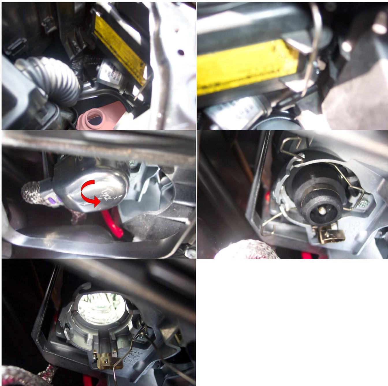
Lorsque les fiches sont connectées à l'ampoule, testez-les avant de tout remonter. Puis tout remettre dans l'ordre inverse. Sur le fond de la boîte à air, il y a une sorte de cheville. Assurez-vous qu'elle aille dans le trou ou elle ne s'adaptera pas correctement.
