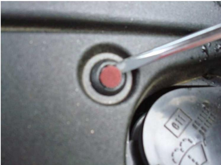
Détachez le fil du capteur du CRG. Ensuite, il suffit de retirer le harnais de la boîte à air. Il y a deux endroits avec cette sorte de crochet et un clip vers le bas.
