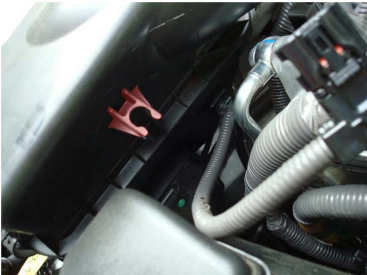
Maintenant, retirez le tuba. Utilisez la méthode à tête plate et enlever la pince sur la gauche. Douille de 10 mm sur la droite. Tirez doucement vers la droite et retirez.
